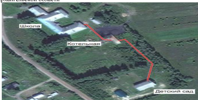
Рисунок 4.3. Схема тепловых сетей д. Скрипчинская муниципального образования «Двинское» Верхнеотоемского муниципального округа Архангельской области
