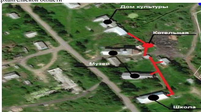
Рисунок 4.4. Схема тепловых сетей д. Кондратовская, д. 64 муниципального образования «Пучужское» Верхнеотоемского муниципального округа Архангельской области
